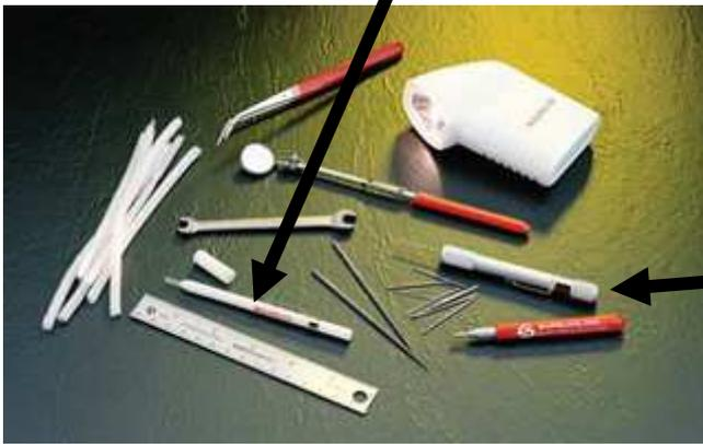
ピンバイスドリルキットは0.33mmから1.61mmまで全14種類のドリル刃とピンバイスがセットになった手動のフェラル用ドリルキットです。硬質、軟質のフェラルに必要な穴をあけられます。ピンバイスはシリンジ針掃除用のワイヤーの保持具としても使えます。(23639 ¥31,500.-)
